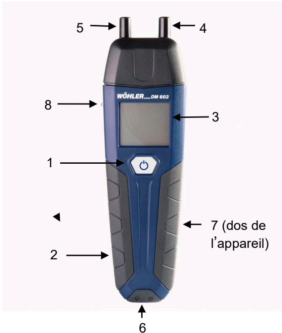
Fig. 9 : Manomètre numérique Wöhler M 602
