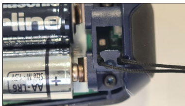
Fig. 8: Fixation de la dragonne au-dessous du compartiment piles
