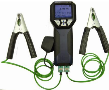
Afb. 4: Aansluiting van twee temperatuurmeettangen
