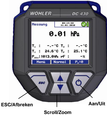
Afb. 13: Display en bedieningstoetsen
