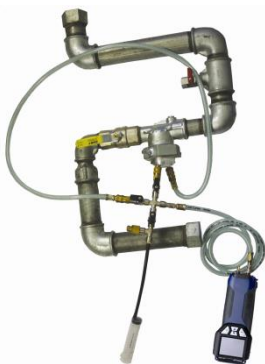
Afb. 32: Aansluitingen bij de volumemeting met de Wöhler DC 410 en spuit (tot 100 ml buisvolume)
