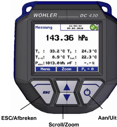
Afb. 7 : Display en bedieningstoetsen
