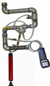
Afb. 33: Aansluitingen bij de volumemeting met de Wöhler DC 410 en roetestpomp (vanaf 100 ml buisvolume)
