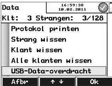
Afb. 47: Voorbereiding op USB-dataoverdracht
