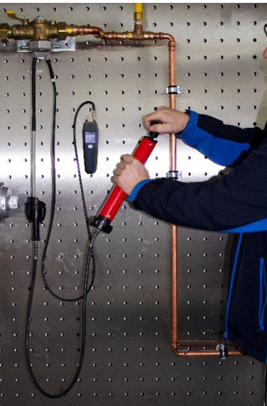
Fig. 29 Buisvolumemeting met Wöhler SC 602 en roetproefpomp
