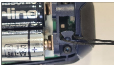
Fig. 2: Bevestiging van de handriem onder het batterijvak
